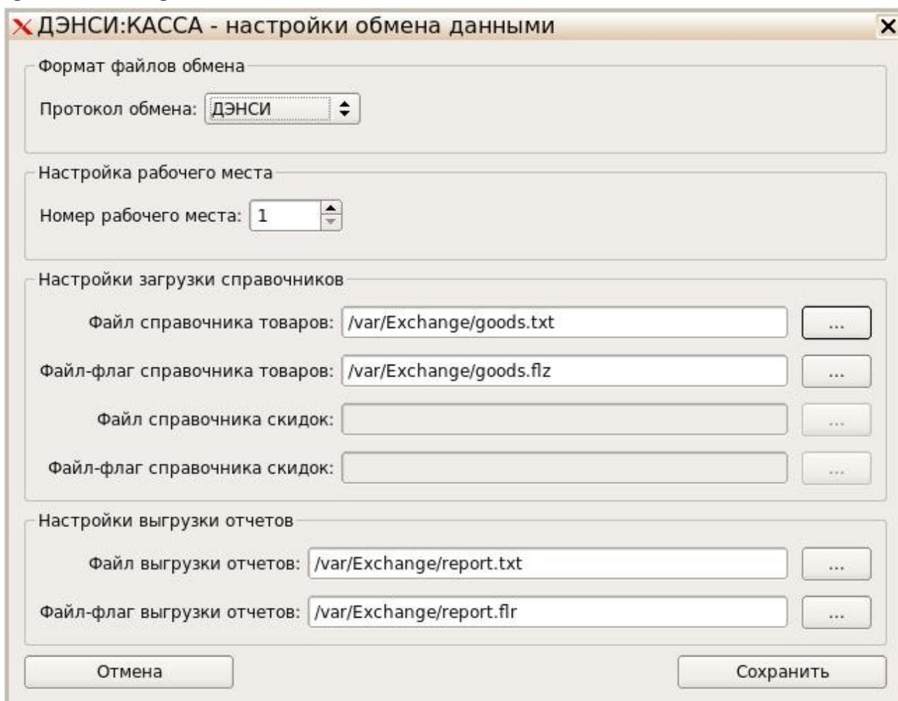
Группа элементов [Настройки загрузки справочников] предназначена для задания параметров загрузки справочника товаров из ТПО в базу данных комплекса «ДЭНСИ: КАССА».
